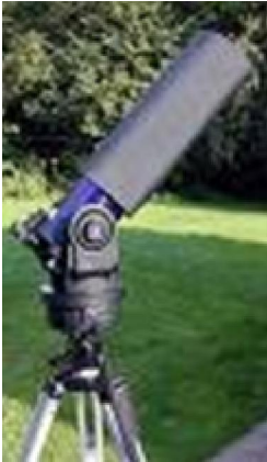
شکل ۵: سپر نوری بسیار بلندی که برای حفاظت از تلسکوپ کوچکی استفاده می‌شود.
